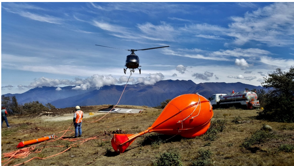
Bild 8. Exempel på en helikopter med en sond för flygburen magnetisk mätning. ( https://expertgeophysics.com/services/ )
