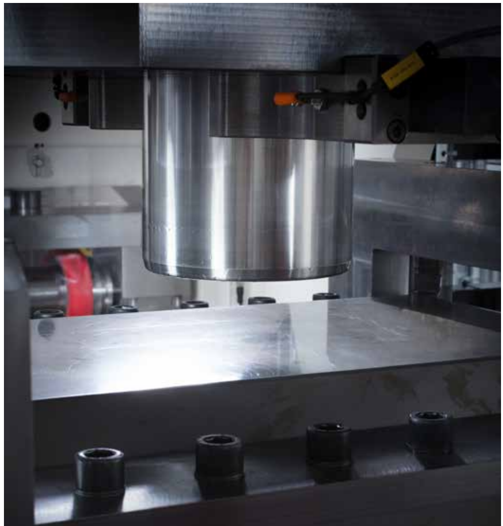
Kolven – några tusendels sekunder före formning av bränslecellsplatta.
