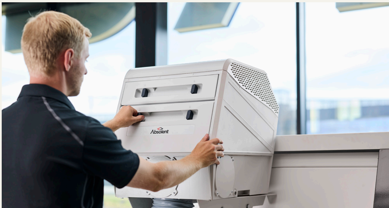
Produkt inom vår nyutvecklade serie med kompakta, maskinmonterade filterenheter för oljedimma.
