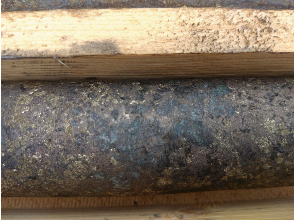
Utdrag av borrhärla i den kraftigt mineraliserade zonen.
