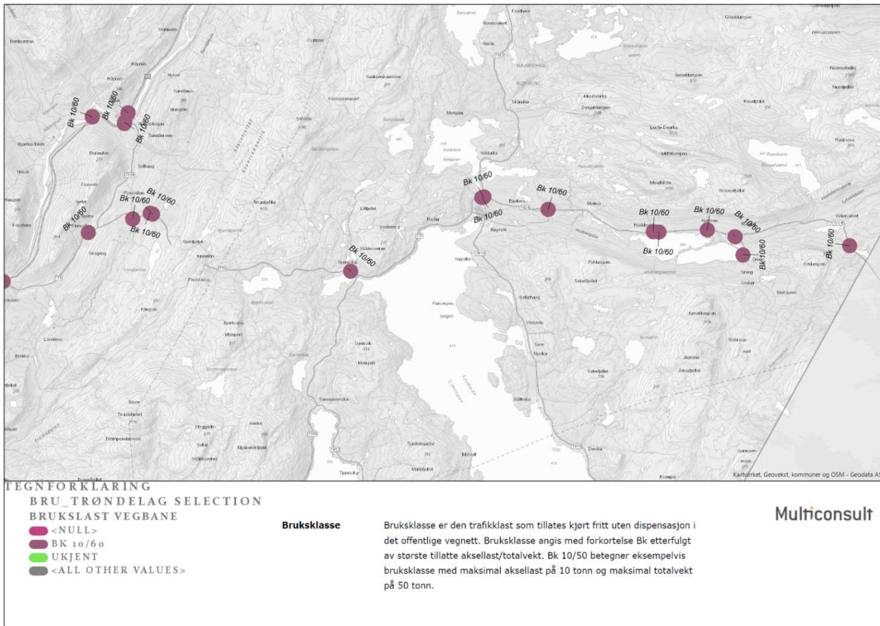
Figur 5 - Bruksklassifisering for aktuelle konstruksjoner på strekningen. Alle konstruksjonene på strekningen er godkjent for 10 tonns aksellast og 60 tonn totalvekt.
