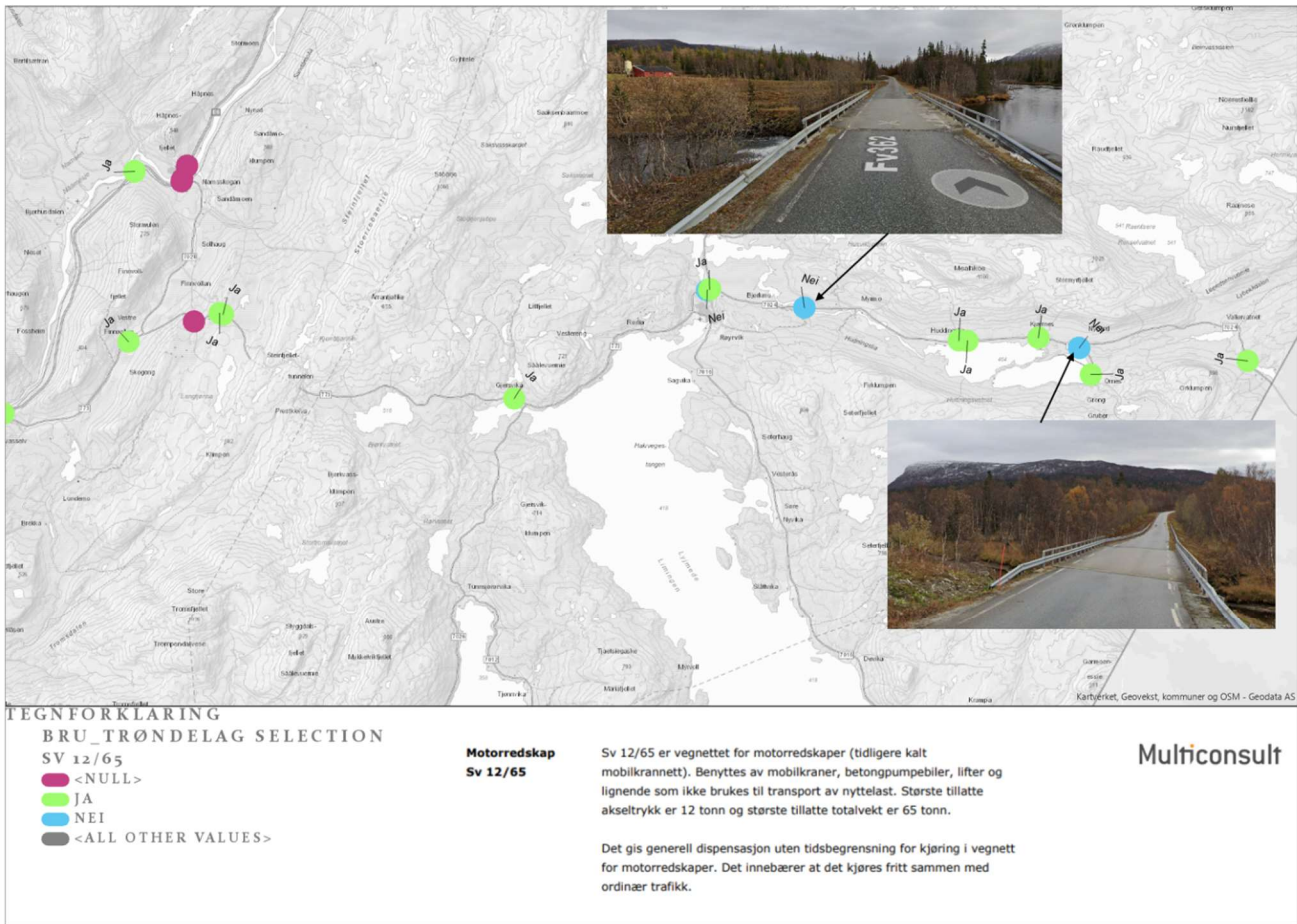
Figur 5 - Konstruksjoner godkjent for 12 tonns akseltrykk og 65 tonn totalvekt. Denne klassen gjelder spesialtransport ofte av kortere lengder.
