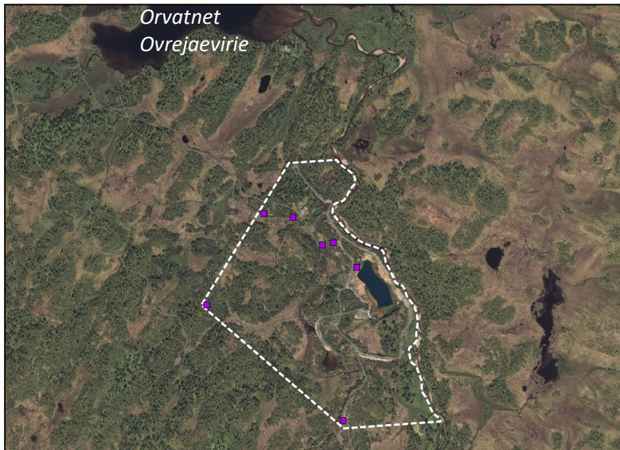
Figur 1-4 Figuren viser planområdet med hvit stiplet linje og de 7 eksisterende luftesjaktene med lilla firkanter.
