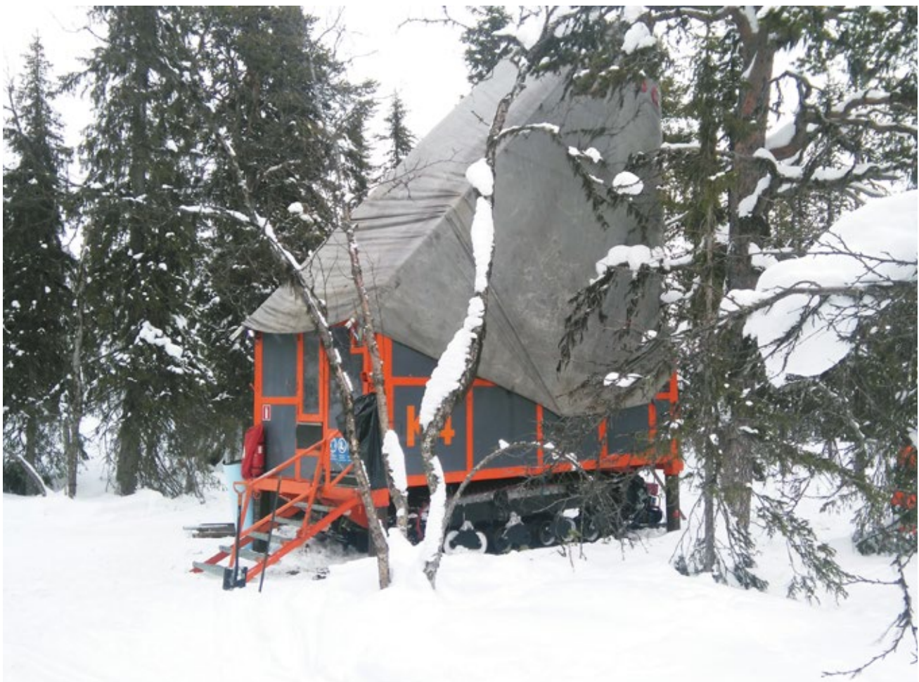
Kärnborrning i vinterlandskap av Arctic Minerals prospekteringsentreprenör ADC, Arctic Drilling Company. Foto: ADC
